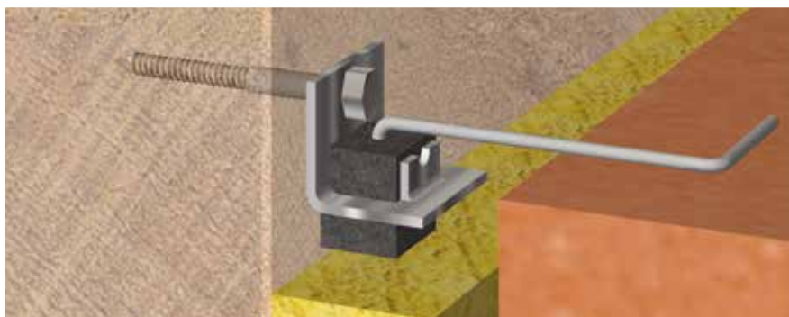
Het uiteinde van de spouwhaak moet langs de onderzijde zichtbaar zijn
